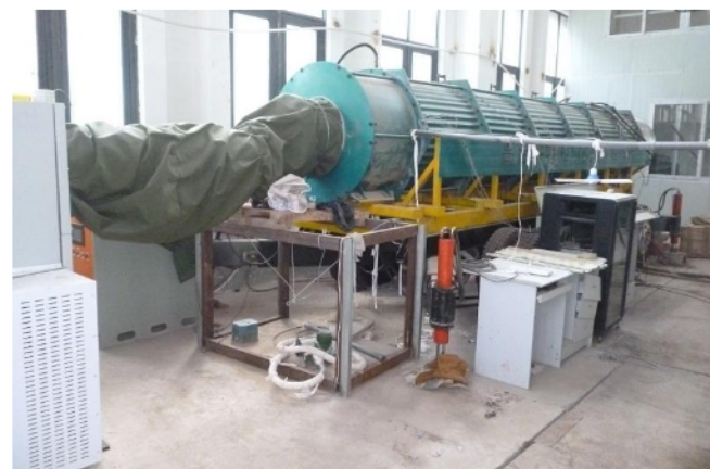
高地温巷道热环境相似模拟试验系统
